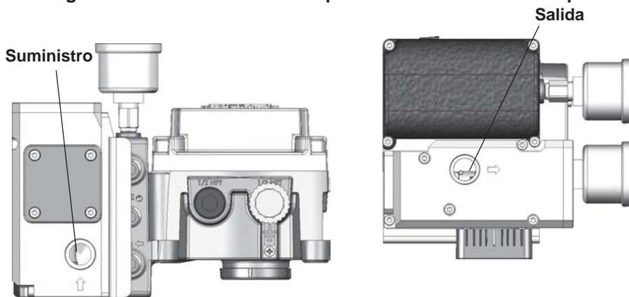
Figura 5 - Puertos de aire de alto flujo en el posicionador de efecto simple del SVI II AP
