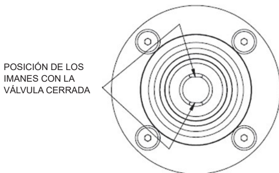
Figura 21 - Posición del imán con la válvula cerrada
